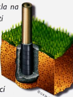
jsou totožné u všech výrobků Elotene Tubi, ale tloušťka jak polyetylenu, tak živičné složky může být odlišná, což ovlivňuje finální charakteristiku výrobku a dává pásu různou průtažnost, pevnost či odolnost. Všechny pásky řady Elotene Tubi, jsou-li správně použity, mají vysokou přilnavost na povrch či na sebe samy (jako například pro vytváření spirály
